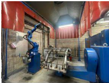
Robots de fixation des godets Ligne automatisée de soudage
