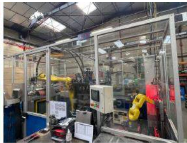
Ligne automatisée de production de raccords à compression
